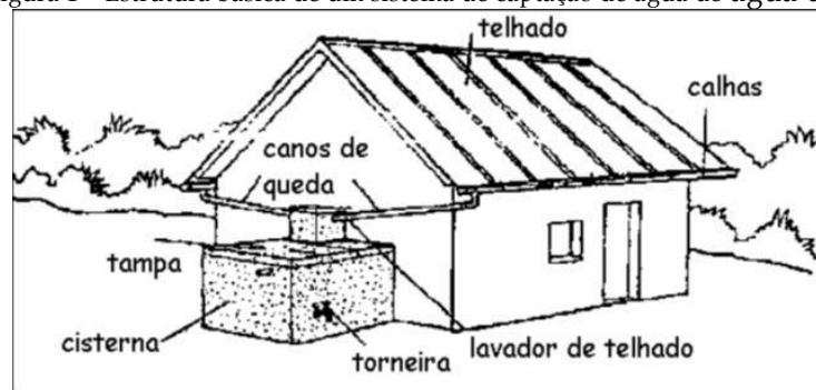
Figura 1 - Estrutura básica de um sistema de captação de água de água da chuva
