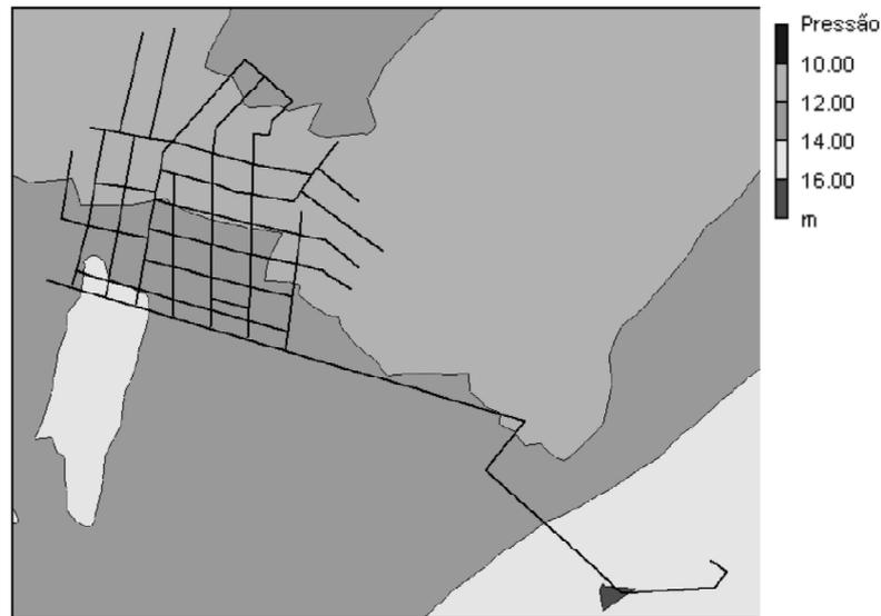
**Figura 4:** Distribuição das pressões (por classes) na rede principal e secundária dimensionada pelo método PNL 2000 modificado.
