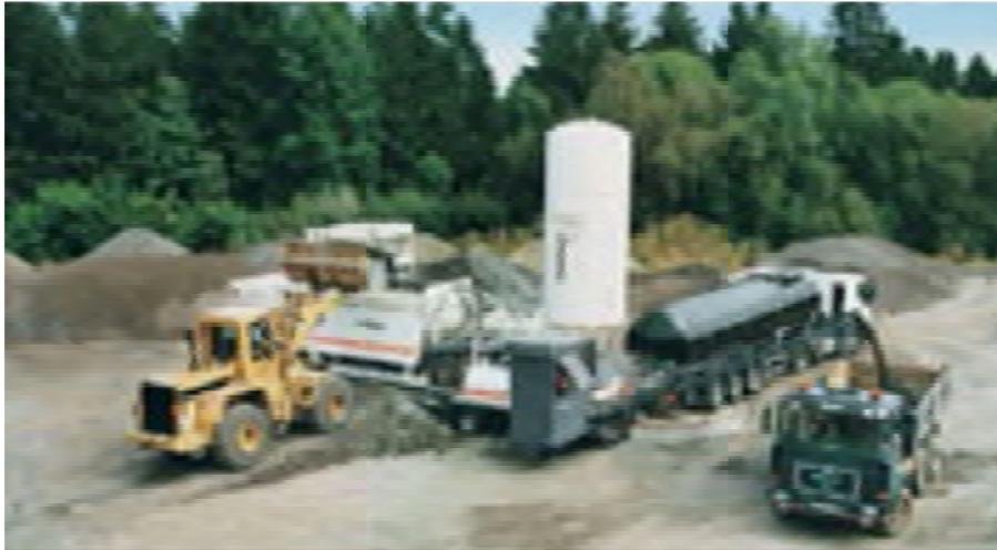
**Figura 11** – Usina móvel p/ misturas frias.
