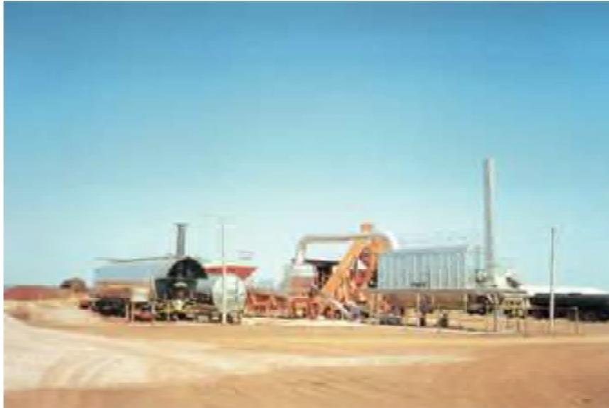
**Figura 9** – Usina de asfalto *Mix Drum*.
