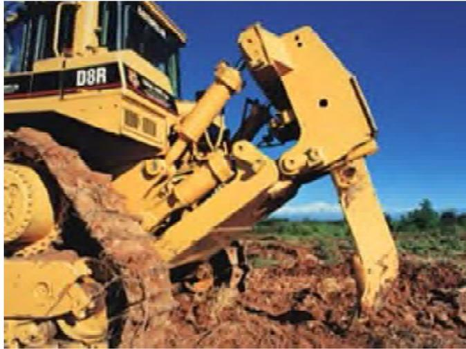
**Figura 8:** Trator pesado equipado com escarificador (**Ripper**).
