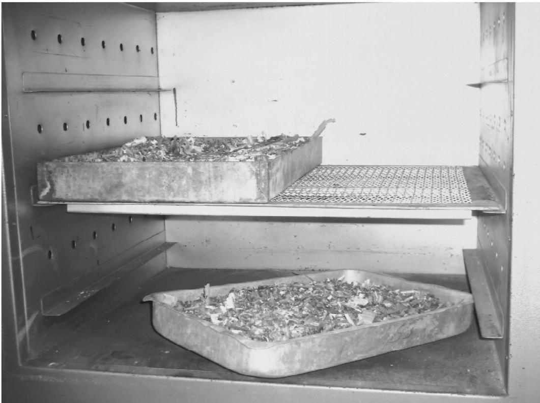
**Figura 1:** Retirada do resíduo de madeira da estufa após secagem sob temperatura controlada.
